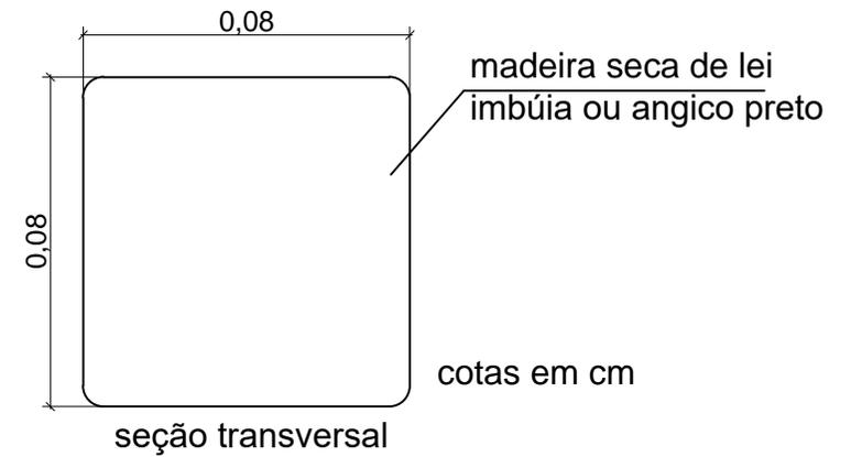
OBS.: Pintadas com tinta látex branco e impermeabilizada a parte que ficará enterrada com cerca de 70 cm. Portanto o tamanho final do poste será de 3,20 m
