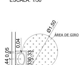
DET. LAVATÓRIO PCD - PLANTA BAIXA ESCALA: 1/50
