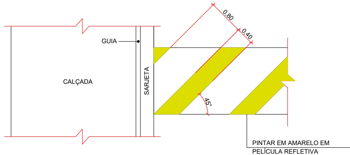
DETALHE CONSTRUTIVO DO OBSTÁCULO REDUTOR DE VELOCIDADE - LOMBADA - (TIPO I)
