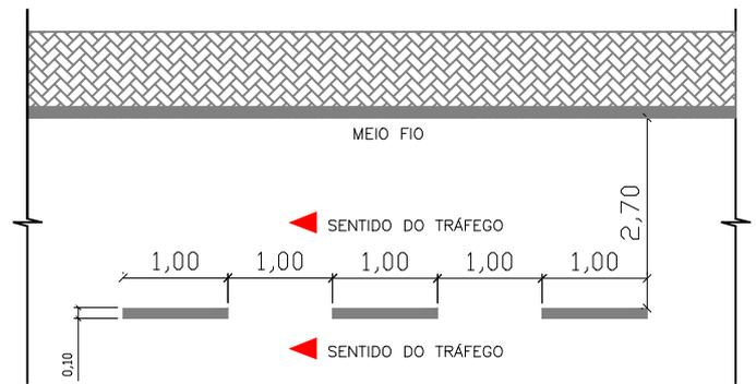
DETALHE DE LINHA DE FECHAMENTO PARA ESTACIONAMENTO SIMPLES PARALELO AO MEIO FIO COM DEMARCAÇÃO AO LONGO DO TRECHO.
