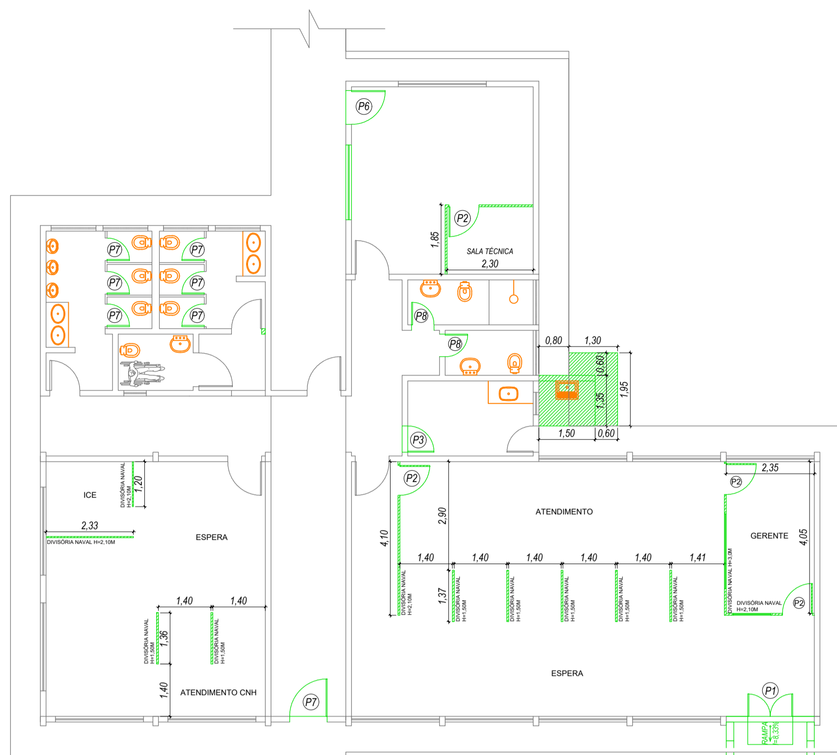
PLANTA DE CONSTRUÇÃO ESCALA: 1/100
