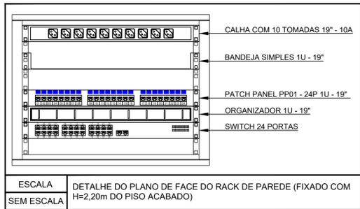
ESCALA DETALHE DO PLANO DE FACE DO RACK DE PAREDE (FIXADO COM H=2,20m DO PISO ACABADO)
