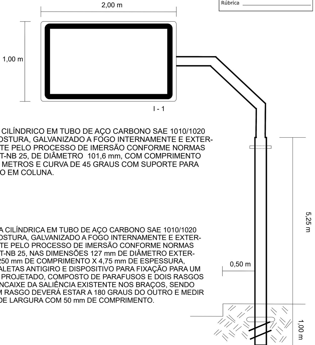
BRAÇO CILÍNDRICO EM TUBO DE AÇO CARBONO SAE 1010/1020 COM COSTURA, GALVANIZADO A FOGO INTERNAMENTE E EXTERNAMENTE PELO PROCESSO DE IMERSÃO CONFORME NORMAS DA ABNT-NB 25, DE DIÂMETRO 101,6 mm, COM COMPRIMENTO DE 4,00 METROS E CURVA DE 45 GRAUS COM SUPORTE PARA FIXAÇÃO EM COLUNA.
