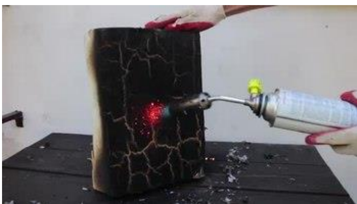
Teste de fogo na placa PIR.
