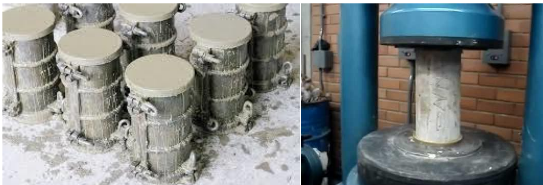
Foto 2 - Teste de compressão do concreto.
