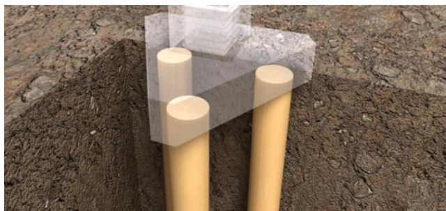
Ilustração de elementos de fundação.
